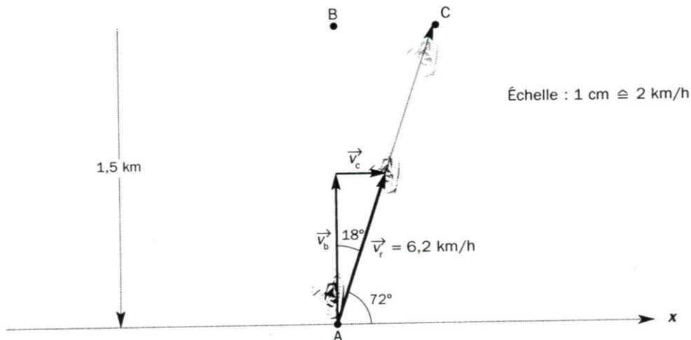
*Le bateau part du point A et vise le point B; le capitaine maintient un cap perpendiculaire à la rive durant toute la traversée. Le courant déporte le bateau vers la droite, c'est-à-dire vers l'aval du cours d'eau, de sorte que le bateau atteindra le rivage au point C.*
