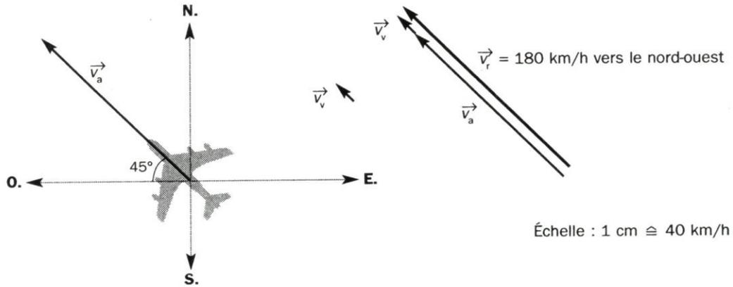
Un vent arrière pousse l'avion de sorte que sa vitesse par rapport au sol ( $v_r$ ) est plus grande que sa vitesse par rapport à l'air ( $v_a$ ), valeur indiquée par les instruments.
